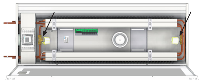
Billede 22. Hvis der vælges en 4-rørs tilslutning, integreres 2 ventiler og aktuatorer i vandedningen (med den ene ventil placeret i modsatte ende af køle/varmebatteriet).
